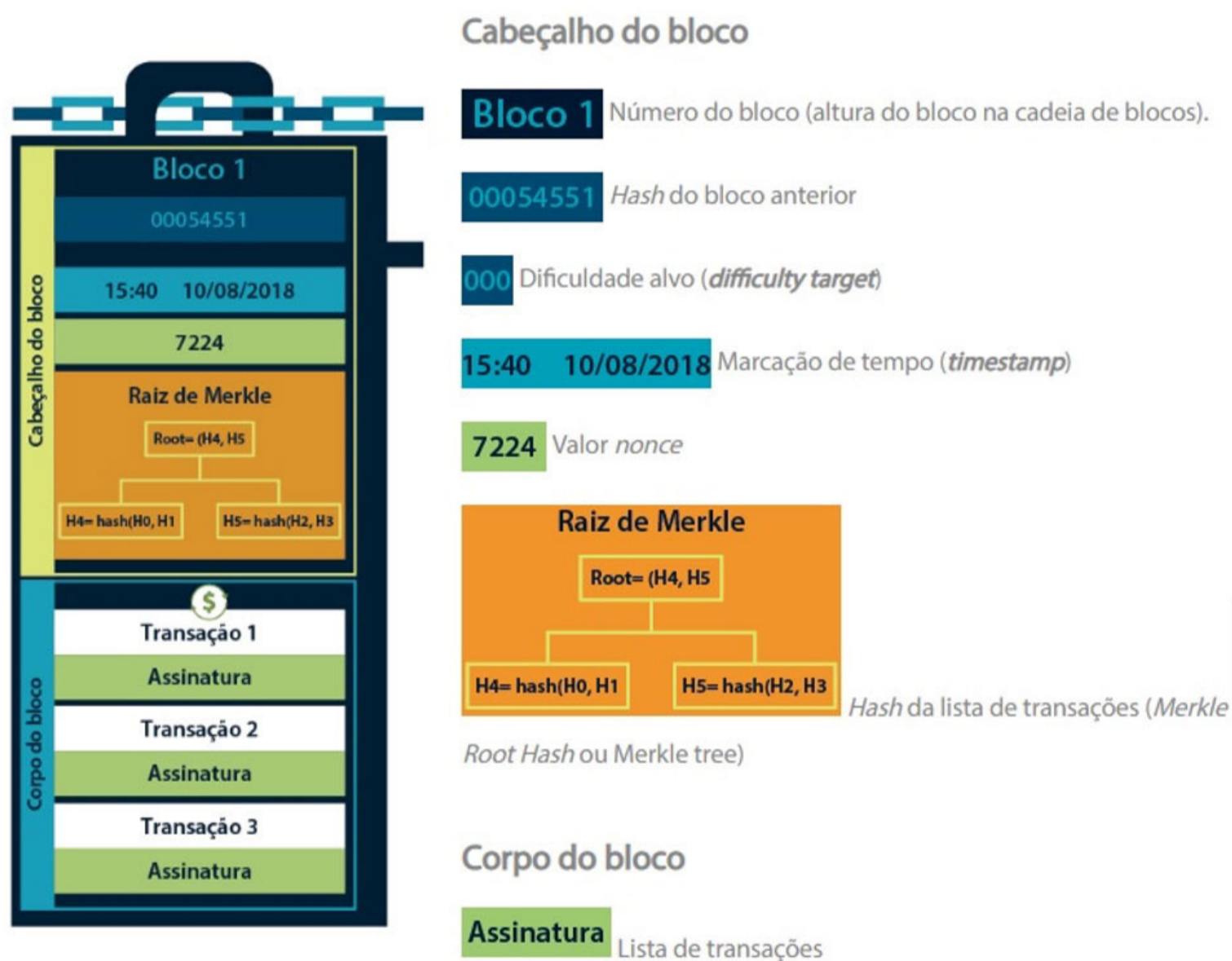
Figura 2: Formato do bloco
